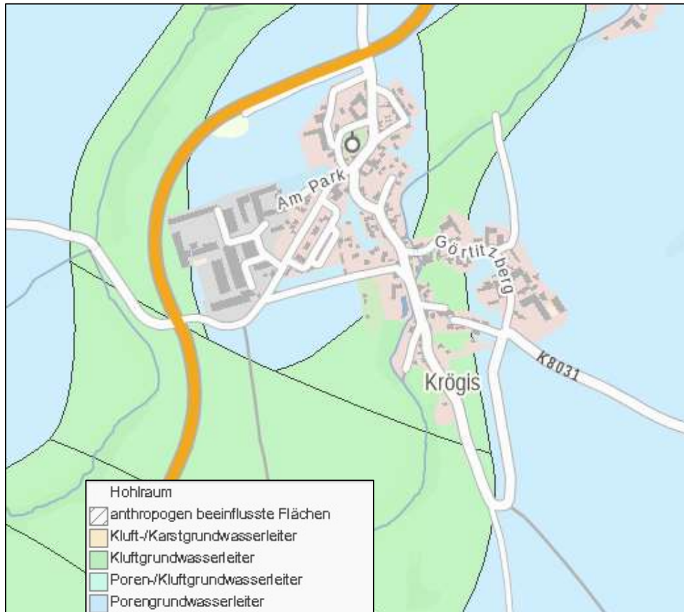
Abbildung 3: Grundwasserleiter im Untersuchungsgebiet (HÜK 200, LfULG)
